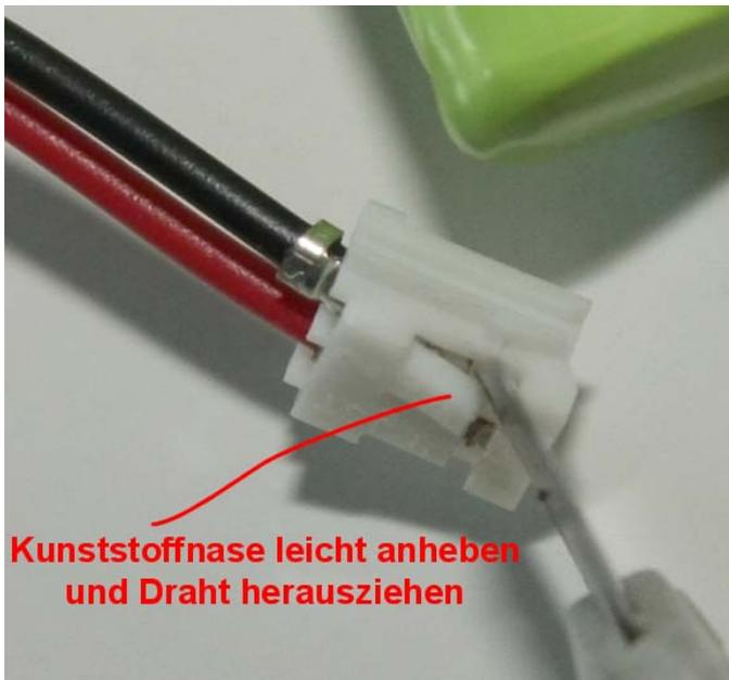
Die Kunststoffnase am Stecker leicht anheben (z.B. mit einem Küchenmesser), so dass der entsprechende Draht heraus gezogen werden kann.
