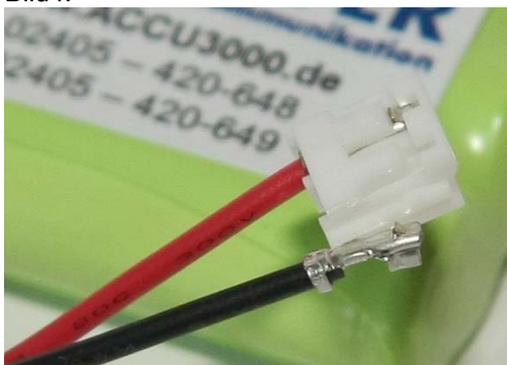
Der Draht mit dem Kontakt ist nun heraus gezogen. Gleicher Vorgang mit dem zweiten Kontakt wie oben beschrieben.
