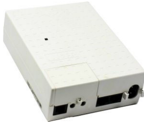
Abbildung 4: NTBA – Netzabschluss des ISDN-Netzes
